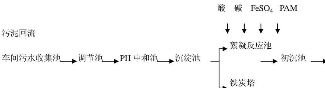
厌氧→生化曝气（兼氧）→沉淀→生气曝气（好氧）→沉淀→达标废水统一进入产业园区污水管网。
