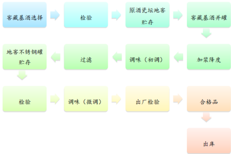
图：原酒酿制工艺流程图
