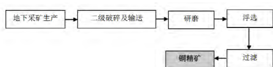
图 3-7：洛阳钼业铜金相关产品生产工艺流程图
