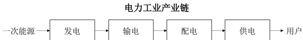
发电是将一次能源通过生产设备转换为电能的过程。可以用于发电的一次能源主要有煤、石油、天然气、水、风能、太阳能和核能等；
