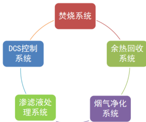
生活垃圾焚烧处理工艺流程（炉排炉）
